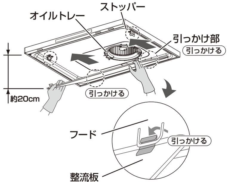
2. 整流板の手前を上を持ち上げ、左右のストッパーにはまるまで押し込む。
